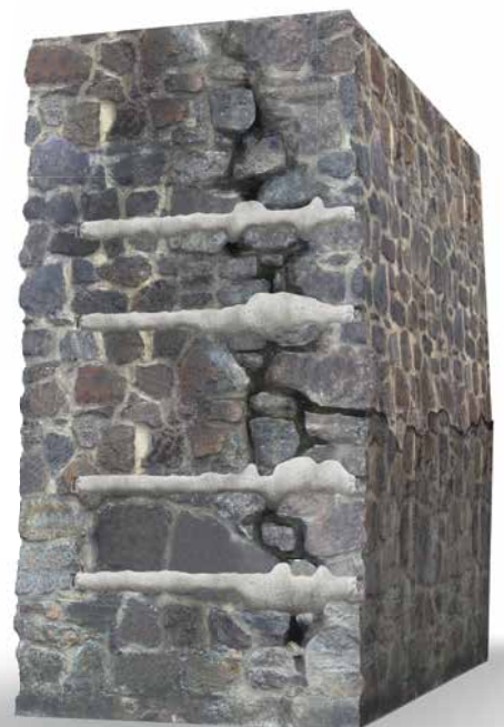
Anbindung abgelöster Mauerwerkschalen Raccordement des murs séparés
