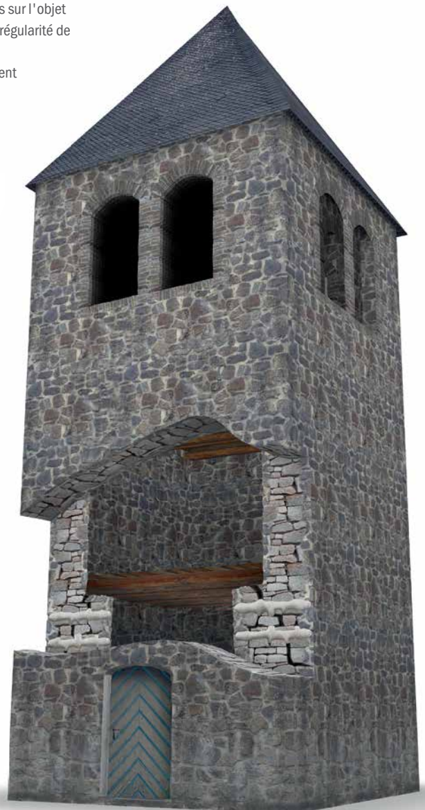
Verbindung abgelöster Mauerwerkschalen Raccordement des murs séparés
