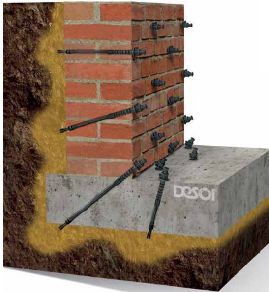
Schleierinjektion | Curtain injection
