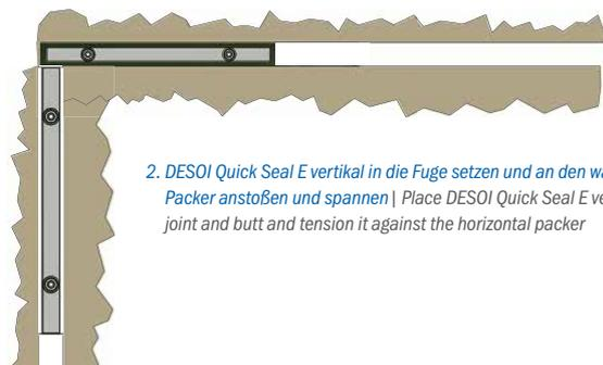
2. DESOL Quick Seal E vertikal in die Fuge setzen und an den waagerechten Packer anstoßen und spannen | Place DESOL Quick Seal E vertically in the joint and butt and tension it against the horizontal packer
