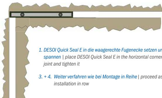
1. DESOL Quick Seal E in die waagerechte Fugenecke setzen und spannen | place DESOL Quick Seal E in the horizontal corner of the joint and tighten it
